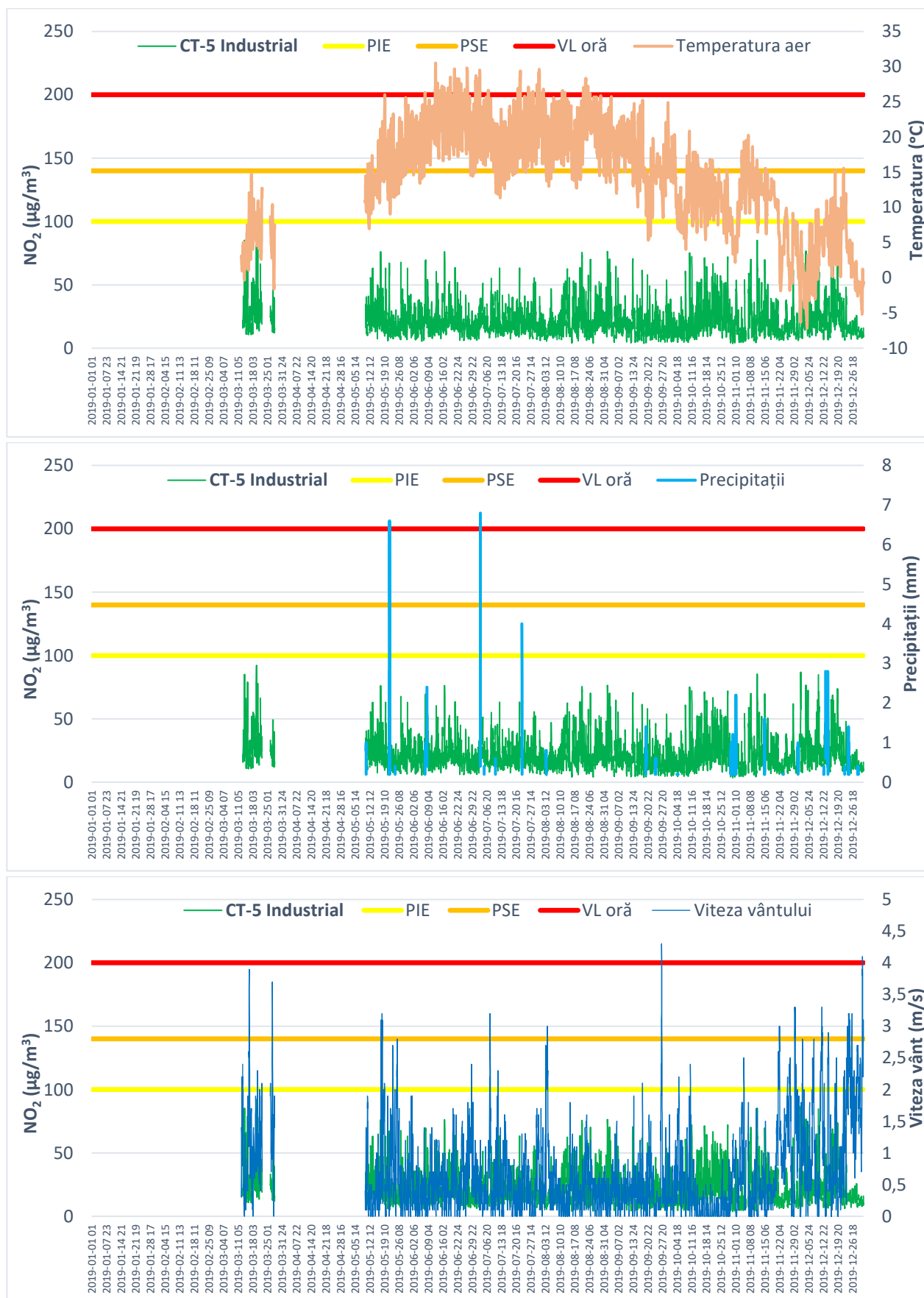
Figura 3-10: Concentrații medii orare pentru dioxid de azot ( \text{NO}_2 ) comparativ cu temperatura aerului, precipitațiile atmosferice și direcția vântului, înregistrate la stația CT-5, în anul 2019
